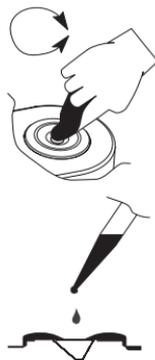
5. Usando una pipetta in plastica, sciacquare prisma e cella con acqua distillata o deionizzata, quindi asciugare. Lo strumento è pronto per il campione seguente.
