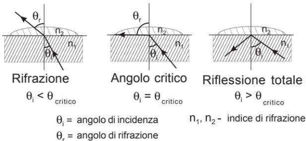
Nel rifrattometro **MA872**, la luce proveniente dal LED passa attraverso un prisma a contatto con il campione. Un sensore di immagine determina l'angolo critico oltre il quale la luce non viene più rifratta attraverso il campione. Lo strumento compensa automaticamente la misura della temperatura e converte l'indice di rifrazione in concentrazione espressa in unità percentuali in peso di Fruttosio.
