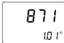
2. Continuando a tener premuto il tasto ON/OFF, premere il tasto ZERO. L'unità di misura della temperatura cambierà da °C a °F o viceversa.
