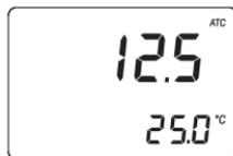
**Nota:** L'indicazione ATC lampeggia sul display e la compensazione automatica della temperatura è disabilitata, se la temperatura è al di fuori dell'intervallo da +10 a +40°C.
